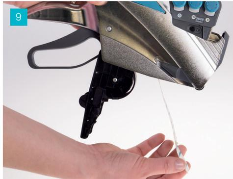
9 Ersatzetiketten durch das Gerät ziehen.
