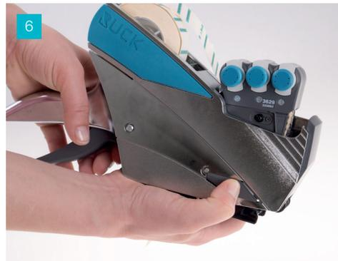
6 Um das Gerät zu öffnen, grauen Kunststoffverschluss zurückziehen.
