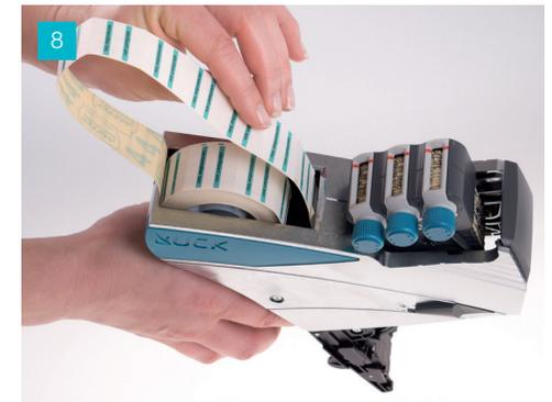
8 Ersatzetiketten in den Führungsschacht einfädeln.
