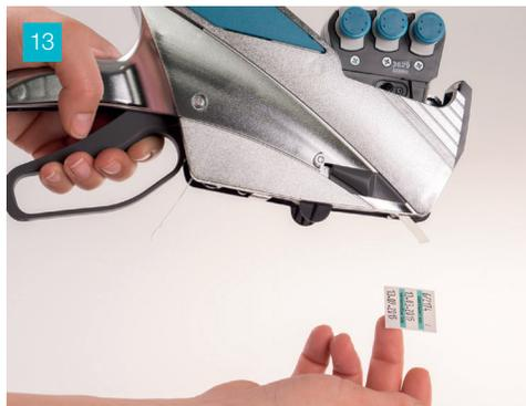
13 Bediengriff mehrfach durchdrücken. Etikettenrolle fädelt sich in die Abrollvorrichtung ein. Auszeichnungsgerät ist betriebsbereit.
