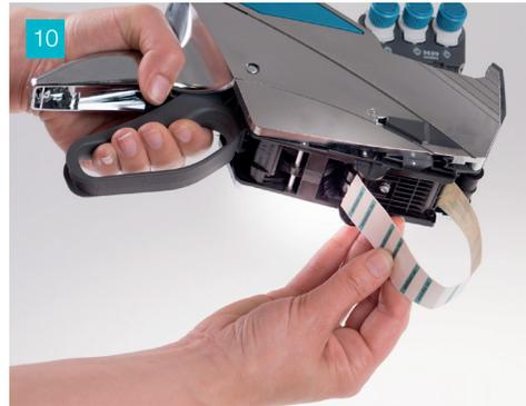
10 In die Abrollvorrichtung einfädeln (Siehe Pfeil Unterseite Gerät).
