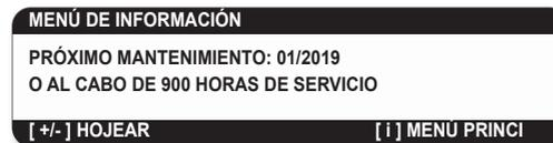
5.5.3 ACTIVACIÓN DEL RECORDATORIO DE MANTENIMIENTO
